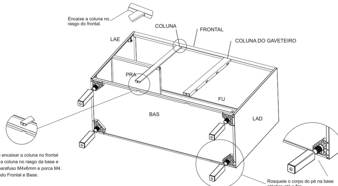
Depois de encaixar a coluna no frontal posicione a coluna no rasgo da base e fixe com parafuso M4x6mm e porca M4. Parafusando Frontal e Base.
